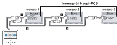
① Gruppensteuerungskabel (PZCWRCG3): Zur Verbindung mit dem Anschluss der Kabel-Fernbedienung des Innengerätes
