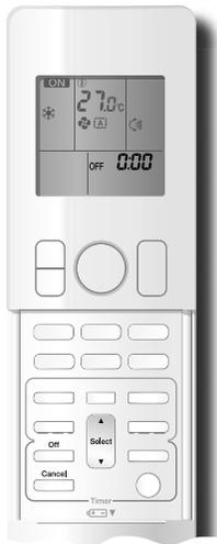
Die Timerfunktionen sind nützlich für die automatische Ein- bzw. Ausschaltung der Klimaanlage am Abend oder am Morgen. Sie können auch den AUS-TIMER und den EIN-TIMER in Kombination verwenden.
