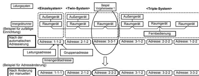
Die obige Adresse wird von der automatischen Adressierung eingestellt, wenn der Strom eingeschaltet wird. Leitungs- und Innengerätadressen werden jedoch zufällig eingestellt. Ändern Sie daher die Einstellung so, dass die Leitungsadressen mit den Innengerätadressen übereinstimmen.
