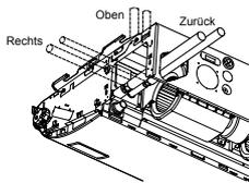
\* Wenn die Kondensatpumpe (nicht im Lieferumfang enthalten) installiert ist, kann die Kältemittelleitung nur nach oben herausgenommen werden.
