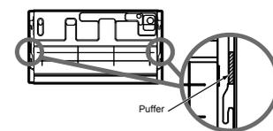
Puffer werden für den Transport zwischen der Seitenwand und dem Aufhängehaken eingefügt. (An den zwei oben angegebenen Stellen) Entfernen Sie sie vor der Installation.
