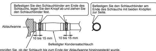
Überprüfen Sie, ob der Schlauch bis zum Ende der Ablaufwanne hineingesteckt wurde.
