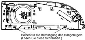
**3** Passen Sie die Länge der beiden Bolzen für die Befestigung des Hängebügels wie unten dargestellt an.
