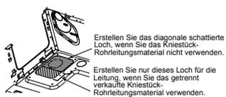
Passen Sie nach Anbringen der Leitung die beigefügte Wärmedämmung der oberen Platte an die Form der Leitung an, und dichten Sie anschließend das Loch ab.
