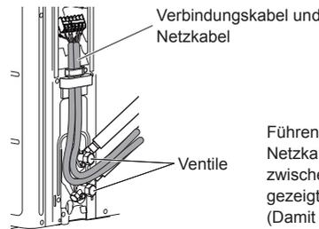
Führen Sie der Verbindungskabel und das Netzkabel auf die Rückseite des Außengeräts zwischen die 2 Ventile, wie in der Abbildung gezeigt.
