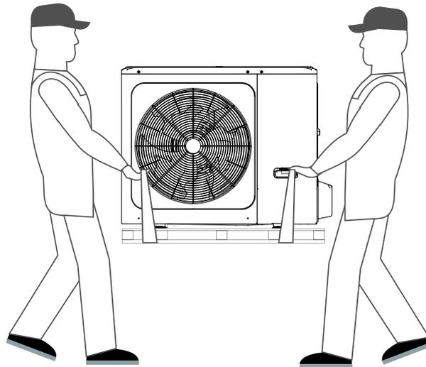
3. Nachdem Sie das Gerät montiert haben, entfernen Sie den Hebegurt vom Gerät, indem Sie an 1 Seite des Hebegurts ziehen.
