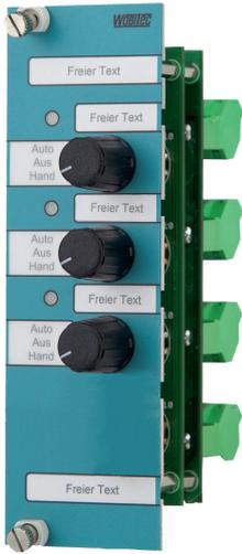
Das Schaltermodul SK-03KL.333.1 wird als Hand- bzw. Notbedienebene zum Übersteuern oder Abschalten des DDC-Signals verwendet. Sie ist mit drei Drehschaltern (jeweils 3 Stellungen) und drei LED's bestückt.
