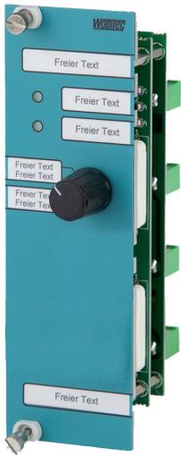
Das Schaltermodul SK-01K.40.1 wird für diverse Steuerungsaufgaben verwendet. Eine der typischen Einsatzmöglichkeiten des Schaltermoduls besteht in der Anwendung für eine Motorsteuerung über eine Hand- bzw. Notbedienebene. Das Schaltermodul ist mit einem Drehschalter (4 Stellungen) sowie mit zwei Leuchtdioden bestückt.
