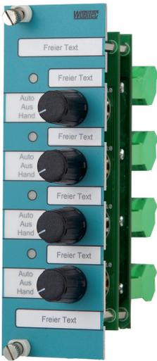
Das Schaltermodul SK-04KLRR.3333.1 wird für diverse Steuerungsaufgaben verwendet. Eine der typischen Einsatzmöglichkeiten des Schaltermoduls besteht in der Anwendung für eine Motorsteuerung über eine Hand- bzw. Notbedienebene. Das Schaltermodul ist mit vier Drehschaltern (jeweils 3 Stellungen) sowie mit vier Leuchtdioden bestückt.
