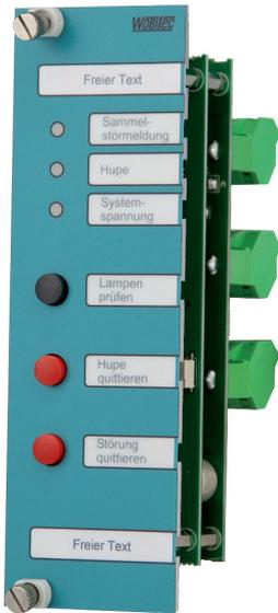
Das Zentralstörmeldemodul ZK-01KA wertet alle Störmeldungen aus, die aus den jeweiligen Melde-, bzw. Steuermodulen angebotenen WobiTec-Bussystem auflaufen. Ausgewertet wird auch zusätzlich eine externe Störmeldung, die auf der Klemme 12 belegt werden kann.
