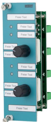
Das Schaltermodul SK-02K.22.1 wird für diverse Steuerungsaufgaben verwendet. Eine der typischen Einsatzmöglichkeiten des Schaltermoduls besteht in der Anwendung für eine Motorsteuerung über eine Hand- bzw. Notbedienebene. Das Schaltermodul ist mit zwei Drehschaltern (jeweils 2 Stellungen) sowie mit vier Leuchtdioden bestückt.
