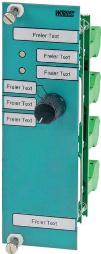
Das Schaltermodul SK-01K.50.1 wird für diverse Steuerungsaufgaben verwendet. Eine der typischen Einsatzmöglichkeiten des Schaltermoduls besteht in der Anwendung für eine Motorsteuerung über eine Hand- bzw. Notbedienebene. Das Schaltermodul ist mit einem Drehschalter (5 Stellungen) sowie mit zwei Leuchtdioden bestückt.
