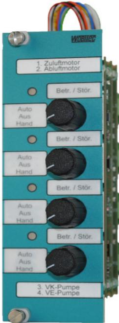
Das Schaltermodul SK-04KW-MOD wird für diverse Steuerungsaufgaben verwendet. Eine der typischen Einsatzmöglichkeiten des Schaltermoduls besteht in der Anwendung für eine Motorsteuerung über eine Hand- bzw. Notbedienebene. Das Schaltermodul ist mit vier Drehschaltern (jeweils 3 Stellungen) sowie mit vier Leuchtdioden bestückt.
