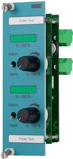
Das Analogausgangsmodul AK-02K.1 erzeugt in der Stellung „Hand“ ein Spannungssignal je Kanal in Höhe von 0-10 Volt (max. 20mA je Kanal). Dieses ist stufenlos über den eingebauten Potentiometer einstellbar.
