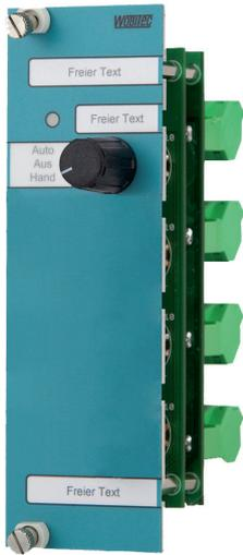
Das Schaltermodul SK-01KL.3.1 wird als Hand- bzw. Notbedienebene zum Übersteuern oder Abschalten des DDC-Signals verwendet. Das Schaltermodul ist mit einem Drehschalter (3 Stellungen) und einer LED bestückt.
