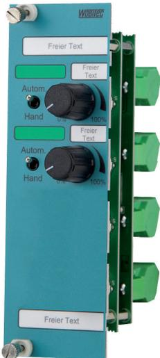
Das Analogausgangsmodul AK-02KL.1 erzeugt in der Stellung „Hand“ ein Spannungssignal je Kanal in Höhe von 0-10 Volt (max. 20mA je Kanal). Dieses ist stufenlos über den eingebauten Potentiometer einstellbar.
