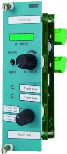
Das Analogausgangsmodul ASK-01K4.1 erzeugt in Stellung „Hand“ ein Spannungssignal in Höhe von 0(2)-10 Volt (max. 20mA). Dieses ist stufenlos über den eingebauten Potentiometer einstellbar.
