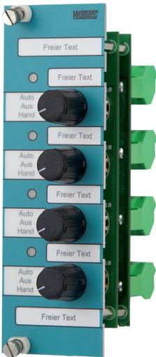
Das Schaltermodul SK-04KLR.3333.1 wird für diverse Steuerungsaufgaben verwendet. Eine der typischen Einsatzmöglichkeiten des Schaltermoduls besteht in der Anwendung für eine Motorsteuerung über eine Hand- bzw. Notbedienebene. Das Schaltermodul ist mit vier Drehschaltern (jeweils 3 Stellungen) sowie mit vier Leuchtdioden bestückt.
