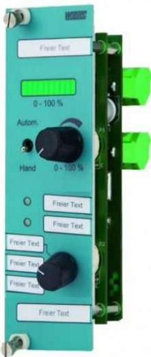
Das Analogausgangsmodul ASK-01K3.1 erzeugt in Stellung „Hand“ ein Spannungssignal in Höhe von 0(2)-10 Volt (max. 20mA). Dieses ist stufenlos über den eingebauten Potentiometer einstellbar.
