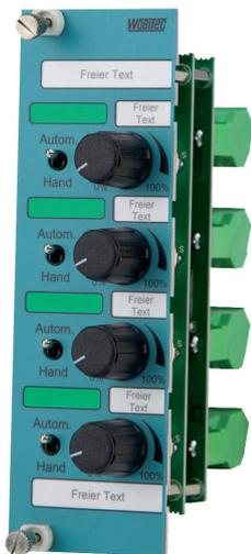
Das Analogausgangsmodul AK-04KL.1 erzeugt in der Stellung „Hand“ ein Spannungssignal je Kanal in Höhe von 0-10 Volt (max. 20mA je Kanal). Dieses ist stufenlos über den eingebauten Potentiometer einstellbar.
