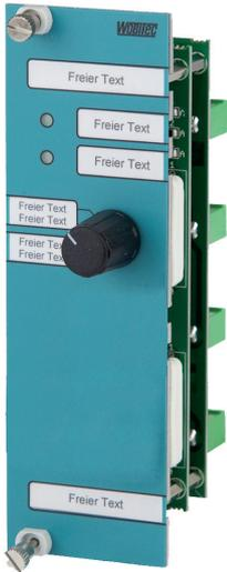
Das Schaltermodul SK-01KRR.40.1 wird für diverse Steuerungsaufgaben verwendet. Eine der typischen Einsatzmöglichkeiten des Schaltermoduls besteht in der Anwendung für eine 2-stufige Motorsteuerung über eine Hand- bzw. Notbedienebene. Das Schaltermodul ist mit einem Drehschalter mit vier Stellungen und 2 LED's bestückt.
