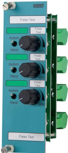
Das Analogausgangsmodul AK-03KL.1 erzeugt in der Stellung „Hand“ ein Spannungssignal je Kanal in Höhe von 0-10 Volt (max. 20mA je Kanal). Dieses ist stufenlos über den eingebauten Potentiometer einstellbar.
