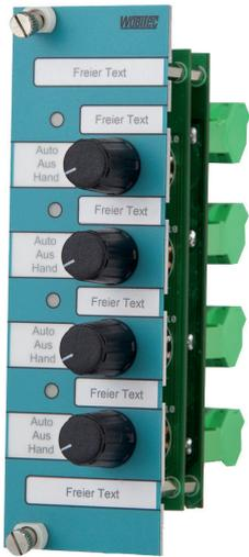
Das Schaltermodul SK-04KL.3333.1 wird als Hand- bzw. Notbedienebene zum Übersteuern oder Abschalten des DDC-Signals verwendet. Das Schaltermodul ist mit vier Drehschalter (jeweils 3 Stellungen) und vier LED's bestückt.
