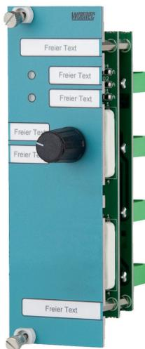
Das Schaltermodul SK-01K.20.1 wird für diverse Steuerungsaufgaben verwendet. Eine der typischen Einsatzmöglichkeiten des Schaltermoduls besteht in der Anwendung für eine Motorsteuerung über eine Hand- bzw. Notbedienebene. Das Schaltermodul ist mit einem Drehschalter (2 Stellungen) sowie mit zwei Leuchtdioden bestückt.
