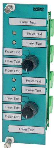
Das Schaltermodul SK-02K.66.1 wird für diverse Steuerungsaufgaben verwendet. Eine der typischen Einsatzmöglichkeiten des Schaltermoduls besteht in der Anwendung für eine Motorsteuerung über eine Hand- bzw. Notbedienebene. Das Schaltermodul ist mit zwei Drehschaltern (jeweils 6 Stellungen) sowie mit vier Leuchtdioden bestückt.
