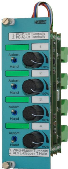
Das Analogausgangsmodul AK-04KL.1-MOD erzeugt in der Stellung „Hand“ ein Spannungssignal je Kanal in Höhe von 0-10 Volt (max. 20mA je Kanal). Dieses ist stufenlos über den eingebauten Potentiometer einstellbar.
