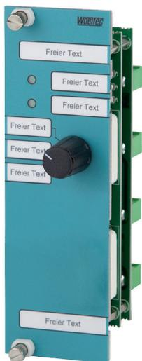
Das Schaltermodul SK-01K.30.1 wird für diverse Steuerungsaufgaben verwendet. Eine der typischen Einsatzmöglichkeiten des Schaltermoduls besteht in der Anwendung für eine Motorsteuerung über eine Hand- bzw. Notbedienebene. Das Schaltermodul ist mit einem Drehschalter (3 Stellungen) sowie mit zwei Leuchtdioden bestückt.
