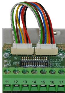
Jede Moduladresse besteht aus 8 Submodulen somit ergibt sich folgender Rechenweg  $(S1+S2+S3+S4+S5+S6+S7+S8)*8+(S9+S10+S11)$
