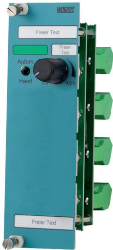
Das Analogausgangsmodul AK-01KL.1 erzeugt in der Stellung „Hand“ ein Spannungssignal in Höhe von 0-10 Volt (max. 20mA). Dieses ist stufenlos über den eingebauten Potentiometer einstellbar.
