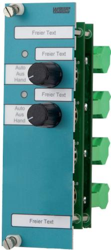
Das Schaltermodul SK-02KL.33.1 wird als Hand- bzw. Notbedienebene zum Übersteuern oder Abschalten des DDC-Signals verwendet. Das Schaltermodul ist mit zwei Drehschaltern (jeweils 3 Stellungen) und zwei LED's bestückt.
