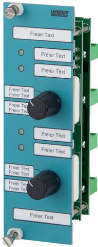
Das Schaltermodul SK-02K.44.1 wird für diverse Steuerungsaufgaben verwendet. Eine der typischen Einsatzmöglichkeiten des Schaltermoduls besteht in der Anwendung für eine Motorsteuerung über eine Hand- bzw. Notbedienebene. Das Schaltermodul ist mit zwei Drehschaltern (jeweils 4 Stellungen) sowie mit vier Leuchtdioden bestückt.
