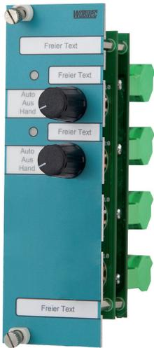
Das Schaltermodul SK-02KLR.33.1 wird für diverse Steuerungsaufgaben verwendet. Eine der typischen Einsatzmöglichkeiten des Schaltermoduls besteht in der Anwendung für eine Motorsteuerung über eine Hand- bzw. Notbedienebene. Das Schaltermodul ist mit zwei Drehschaltern (jeweils 3 Stellungen) sowie mit zwei Leuchtdioden bestückt.
