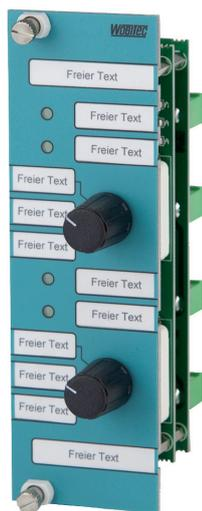
Das Schaltermodul SK-02K.33.1 wird für diverse Steuerungsaufgaben verwendet. Eine der typischen Einsatzmöglichkeiten des Schaltermoduls besteht in der Anwendung für eine Motorsteuerung über eine Hand- bzw. Notbedienebene. Das Schaltermodul ist mit zwei Drehschaltern (jeweils 3 Stellungen) sowie mit vier Leuchtdioden bestückt.
