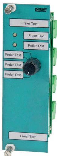
Das Schaltermodul SK-01K.60.1 wird für diverse Steuerungsaufgaben verwendet. Eine der typischen Einsatzmöglichkeiten des Schaltermoduls besteht in der Anwendung für eine Motorsteuerung über eine Hand- bzw. Notbedienebene. Das Schaltermodul ist mit einem Drehschalter (6 Stellungen) sowie mit zwei Leuchtdioden bestückt.
