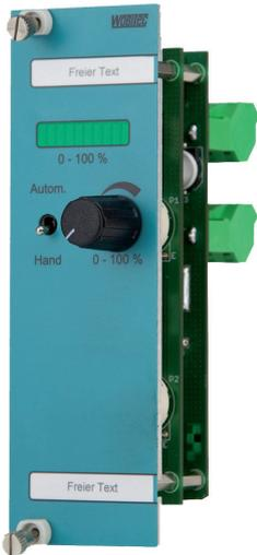
Das Analogausgangsmodul AK-01K.1 erzeugt in der Stellung „Hand“ ein Spannungssignal in Höhe von 0-10 Volt (max. 20mA). Dieses ist stufenlos über den eingebauten Potentiometer einstellbar.
