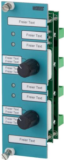
Das Schaltermodul SK-02KRR.44.1 wird für diverse Steuerungsaufgaben verwendet. Eine der typischen Einsatzmöglichkeiten des Schaltermoduls besteht in der Anwendung für eine 2-stufige Motorsteuerung über eine Hand- bzw. Notbedienebene. Das Schaltermodul ist mit zwei Drehschaltern mit jeweils vier Stellungen und 4 LED's bestückt.
