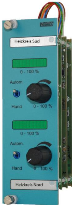
Das Analogausgangsmodul AK-02K.1-MOD erzeugt in der Stellung „Hand“ ein Spannungssignal je Kanal in Höhe von 0-10 Volt (max. 20mA je Kanal). Dieses ist stufenlos über den eingebauten Potentiometer einstellbar.
