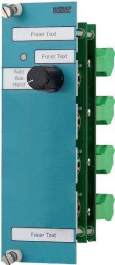
Das Schaltermodul SK-01KLRR.3.1 wird für diverse Steuerungsaufgaben verwendet. Eine der typischen Einsatzmöglichkeiten des Schaltermoduls besteht in der Anwendung für eine Motorsteuerung über eine Hand- bzw. Notbedienebene. Das Schaltermodul ist mit einem Drehschalter (3 Stellungen) sowie mit einer Leuchtdiode bestückt.
