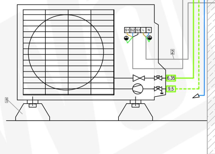
Kondensatablauf mit Kanalpumpe FL-K20K-SW rechts
