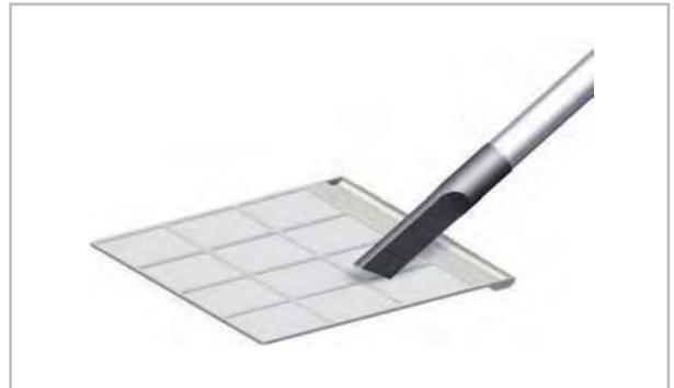
Abb. 39: Reinigung mit dem Staubsauger
