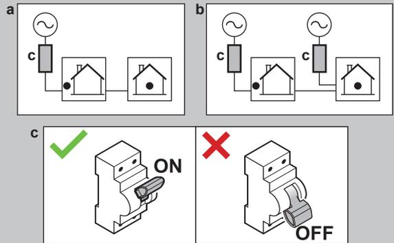
Bringen Sie zur Warnung des Benutzers die Aufkleber "Schutzschalter NICHT AUSSCHALTEN" im Schaltschrank und so nah wie möglich an den Schutzschaltern der Wärmepumpe an. Tragen Sie für größtmögliche Klarheit die Referenznummer des Schutzschalters auf dem Aufkleber ein.
