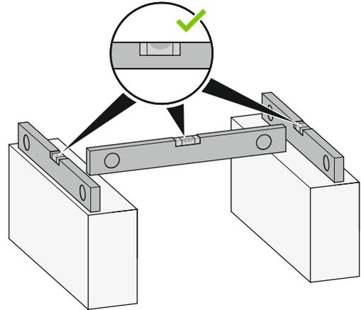
Verwenden Sie 4 Sätze mit M12-Ankerbolzen, Muttern und Unterlegscheiben. Lassen Sie mindestens 150 mm Freiraum unter dem Gerät. Stellen Sie zusätzlich sicher, dass das Gerät mindestens 100 mm über der maximal zu erwartenden Schneehöhe positioniert ist.
