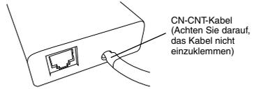
4. Den Netzwerkadapter ⑥ an der Netzwerkadapter-Halterung befestigen. Das Kabel wie im Diagramm gezeigt führen, damit keine äußeren Kräfte auf den Steckverbinder im Adapter einwirken können.
