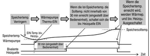
Bivalente Heizquelle Im Erweiterten Parallelbetrieb ist eine getrennte Einstellung für Pufferspeicher und Warmwasserspeicher möglich. Während des Heiz- und Warmwasserbetriebs („HEAT+TANK“) wird der Bivalenzausgang bei jeder Umschaltung der Betriebsart auf AUS zurückgesetzt. Für die Auswahl der optimalen Einstellung für das System ist ein gutes Verständnis der der Bivalenzfunktion erforderlich.
