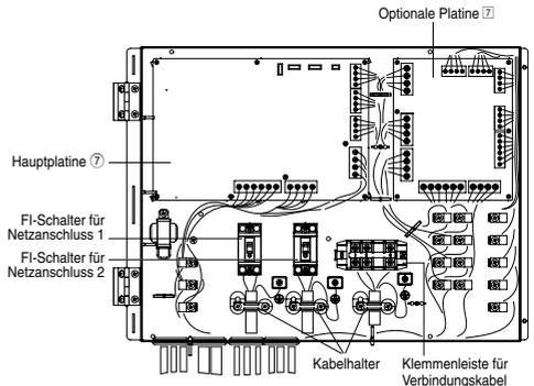
Führung der optionalen Kabel und Netzkabel
