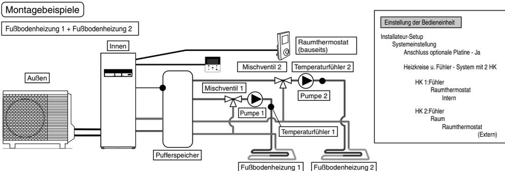
Beide Heizkreise für Fußbodenheizung über den Pufferspeicher an das Innengerät anschließen, wie in der Abbildung dargestellt ist.
