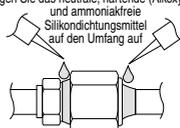
Das neutrale, härtende (Alkoxy-Typ) und ammoniakfreie Silikonichtungsmittel wird erst nach dem Drucktest und Reinigen und nur auf die Außenseite des Anschlusses unter Beachtung der folgenden Anweisungen angebracht. Ziel ist es, dass keine Feuchtigkeit in die Fugenverbindung gelangt und dass vor Frost geschützt wird. Das Härten des Dichtungsmittels wird etwas Zeit in Anspruch nehmen. Stellen Sie sicher, dass sich das Dichtungsmittel beim Isolieren nicht ablöst.
