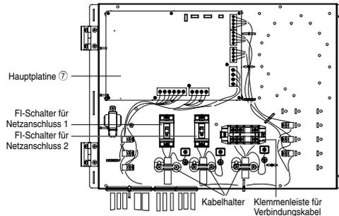
Führung der optionalen Kabel und Netzkabel
