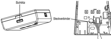
3. Ziehen Sie das CN-CNT-Kabel durch die Öffnung an der Unterseite des Adapters, und bringen Sie die vordere Abdeckung wieder an der hinteren Abdeckung an.
