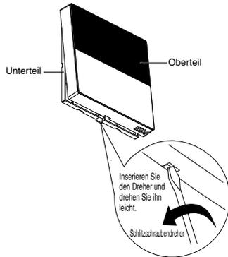
3. Die Schritte 1 bis 4 aus dem Abschnitt „Ausbauen der Bedieneinheit aus der Hydromodul/Speicher-Einheit“ umkehren, um das Gehäuse der Bedieneinheit ⑤ an der Hydromodul/Speicher-Einheit zu befestigen.
