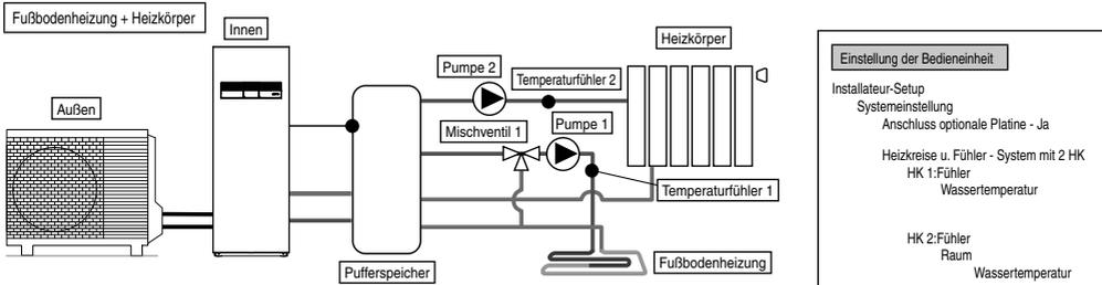
Einen Heizkreis für Fußbodenheizung und einen zweiten Heizkreis für Heizkörper über den Pufferspeicher an das Innengerät anschließen, wie in der Abbildung dargestellt ist.
