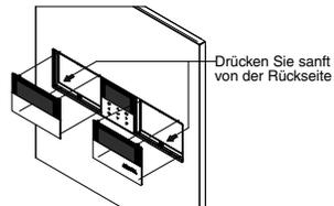
2. Die 4 Schrauben entfernen und die Halterung mit der Bedieneinheit ① herausnehmen.
