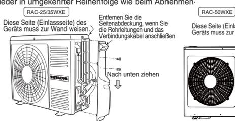
**⚠️ VORSICHT** • Berühren Sie nicht den Sauganschluss, die untere Fläche oder die Aluminiumlamellen des Außengeräts, da dies zu Verletzungen führen kann.
