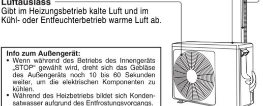
Info zum Außengerät: Wenn während des Betriebs des Innengeräts „STOP“ gewählt wird, dreht sich das Gebläse des Außengeräts noch 10 bis 60 Sekunden weiter, um die elektrischen Komponenten zu kühlen.
