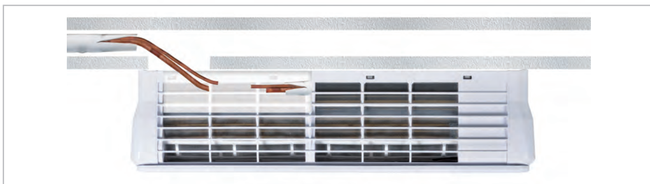
Abb. 33: Unterputzinstallation der Kältemittelleitungen (Ansicht von oben)
