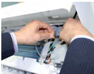
Abb. 55: Mit der Display- und Steuerplatine verbinden
