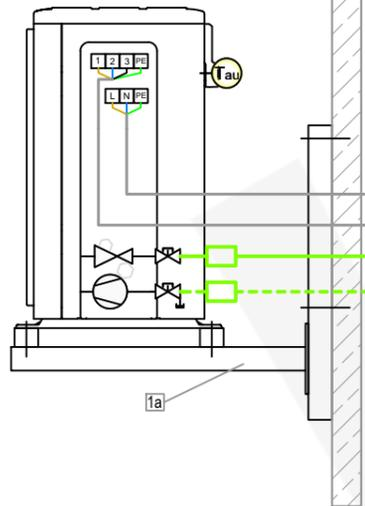
Aussengerät mit Dämpfungssockel
