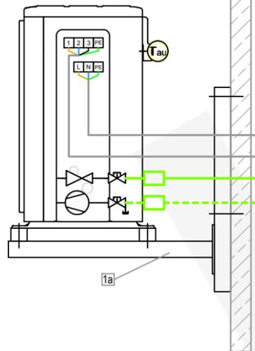
Aussengerät mit Dämpfungssockel (Aufstellbalken)
