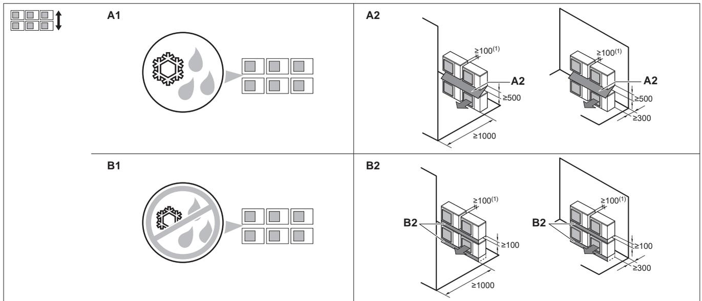
(1) Sorgen Sie dafür, dass ein Abstand von  $\geq 250$  mm eingehalten wird, damit Wartungsarbeiten ungehindert durchgeführt werden können.
