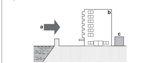
Wenn die Außeneinheit so installiert ist, dass sie Seewinden direkt ausgesetzt ist, installieren Sie einen Windschutz.
