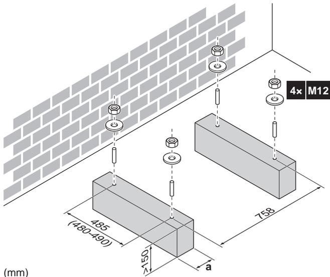
a Die Abflusslöcher der Bodenplatte der Einheit müssen frei sein.
