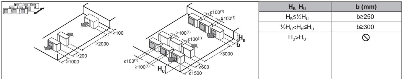
(1) Sorgen Sie dafür, dass ein Abstand von  $\geq 250$  mm eingehalten wird, damit Wartungsarbeiten ungehindert durchgeführt werden können.
