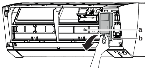
a Schraube von Wartungsblende b Wartungsblende
