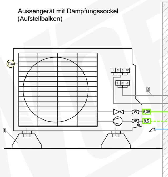
Kondensatablauf mit Kanalpumpe FL-K20K-SW links
