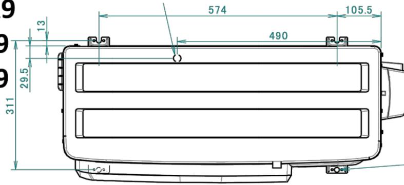
4 Bohrungen für Ankerschrauben
