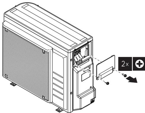
2 Entfernen Sie die Abdeckung der Kältemittelleitung.
