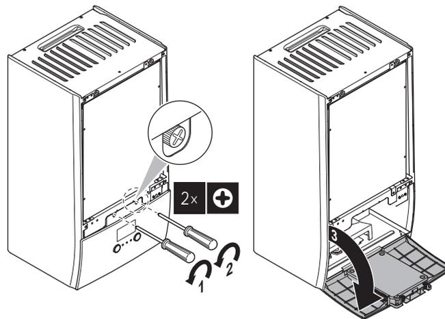
5 Optional: Entfernen Sie die Blende der Bedieneinheit.
