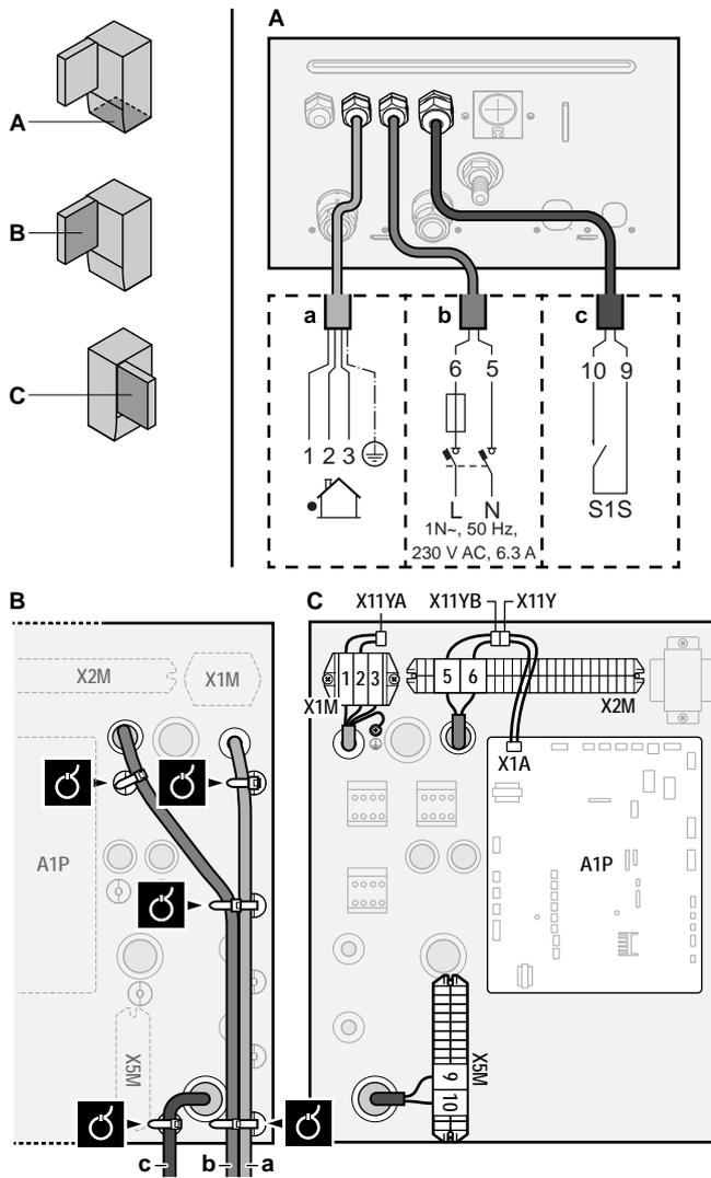
a Verbindungskabel (=Hauptstromversorgung)
