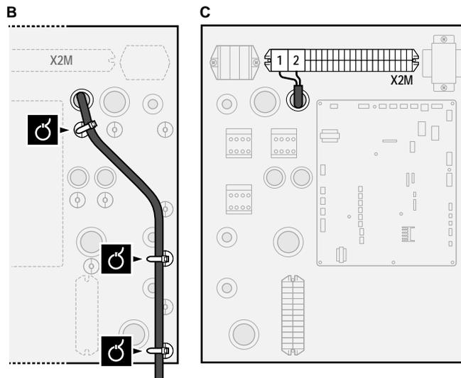
3 Das Kabel mit Kabelbindern an den Kabelbinderhalterungen befestigen.
