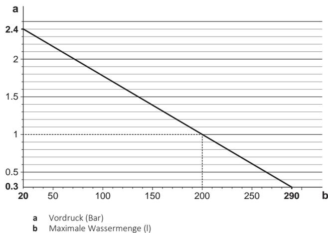
**Beispiel: Maximale Wassermenge und Vordruck des Ausdehnungsgefäßes**
