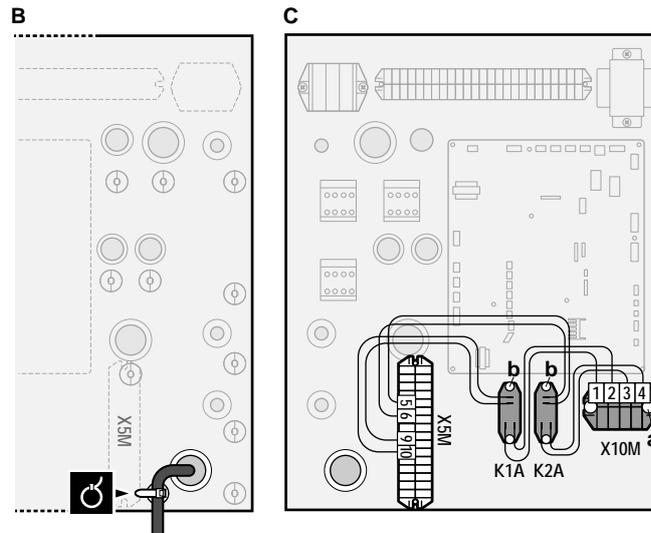
2 Schließen Sie die Niederspannungskabel wie folgt an:
