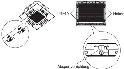
1. Schieben Sie die Hebel des Einlassgitters in Pfeilrichtung (⇒), und öffnen Sie es nach unten hin.
