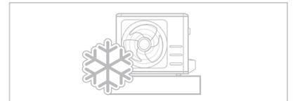
✓ Wenn Schneefall zu erwarten ist, ergreifen Sie geeignete Maßnahmen, um Eisbildung und Schäden an den Spulen zu verhindern.
