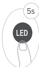
Drücken Sie diese Taste länger als 5 Sekunden (einige Einheiten)
