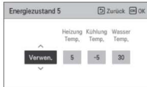
Im Menüpunkt „**Definition des Energiezustands**“ können sie unter den einzelnen Energiezuständen auswählen. Die Energiezustände 5-8 sind frei programmierbar. Es können dort die Heiztemperatur, die Kühltemperatur und die Brauchwassertemperatur verändert werden. Links im Bild ein Beispiel. Hier würde nun im Energiezustand 5 die Heiztemperatur um 5 Kelvin angehoben, die Kühltemperatur um 5 Kelvin gesenkt und die Brauchwassertemperatur um 30 Kelvin angehoben werden.
