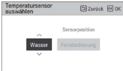
In den allermeisten Fällen werden sie die Wärmepumpe nach der Vorlauf-oder Rücklauf-temperatur regeln wollen. In diesem Fall ist „**Wasser**“ zu wählen.
