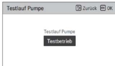
Mit dieser Funktion können sie die interne Primärkreispumpe probelaufen lassen. Dies kann zum Beispiel bei der Entlüftung der Anlage hilfreich sein. Der Probelauf ist auf die Zeitdauer von einer Stunde festgelegt.
