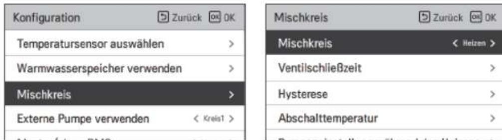
Die Funktion „ Mischkreis“ ermöglicht es, dass die Wärmepumpe zwei unterschiedliche Heizkreise steuert. Die Funktion muss aktiviert werden auf „Heizen“ oder „Heizen und Kühlen“ (Kühlen erscheint nur, wenn auch der DIP-Schalter 4 auf SW2 entsprechend aktiviert wurde).
