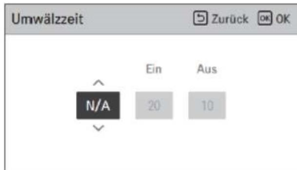
Die LG Wärmepumpe kann auch eine Zirkulationspumpe ansteuern. Diese Funktion muss aktiviert werden (verwenden). Nun können sie in der Benutzerebene unter Zeitplan einstellen, wann diese arbeiten soll. Die Zeiteinstellungen „Ein“ und „Aus“ Im Menüpunkt Brauchwasser => Umwälzzeit sind zugunsten der weit komfortableren Einstellungen im „Zeitplanmenü“ ohne Funktion. Benutzen sie die Pfeiltasten um sich im Menü „Zeitplan“ zu bewegen.
