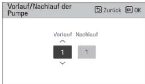
Diese Einstellung regelt den internen Pumpenbetrieb (Primärkreispumpe) in der Wärmepumpe vor und nach dem Betrieb des Verdichters. Er sichert eine ausreichende Strömung vor dem Verdichterbetrieb und verhindert einen Druckanstieg nach dessen Abschaltung. Wir empfehlen jeweils 1 Minute einzustellen.
