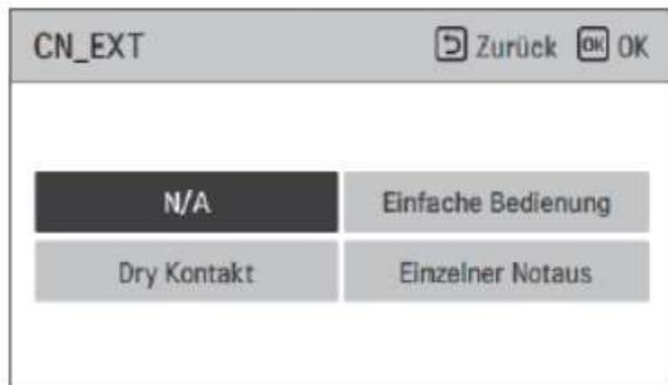
Neben der Nutzung eines Drykontaktes aus dem Zubehör, gibt es weiterhin noch die Möglichkeit über den mitgelieferten Stecker eine einfache Drykontaktfunktion durchzuführen. Diesen Stecker Bitte auf den **Steckplatz CN\_EXT** auf der rechten Hydroplatine einstecken. Er arbeitet potenzialfrei und kann durch ein beliebiges Relais geschaltet werden. Wählen sie bitte **Einfache Bedienung** für An/Aus und **Einzelner Notaus** für Aus/ Freigabe zum Wiedereinschalten
