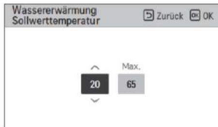
In den allermeisten Fällen jedoch werden sie jedoch die Wärmepumpe nach einer Wassertemperatur regeln wollen. Ob mit dem Vorlauf oder Rücklauf haben sie ja bereits weiter oben bei Heiz Temp. Einstellung entschieden. Hier legen sie nun fest, welche Wassertemperaturwerte in der Bediener Ebene überhaupt ausgewählt werden können. Wir empfehlen den Maximalwert von 55°C nicht zu überschreiten.
