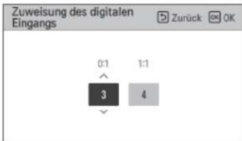
Jetzt müssen sie noch im Menü „**Zuweisung des digitalen Eingangs**“ festlegen, welcher Schaltzustand von ES1 und ES2, welchem Energiezustand zugeordnet werden. Im Beispiel hier wäre ES1=0 und ES2=1 dem Energiezustand 3 zugeordnet und ES1=1 und ES2=1 dem Energiezustand 4
