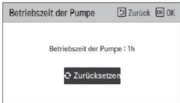
In diesem Menü können sie die Betriebszeit der internen Wasserpumpe in der Wärmepumpe auslesen und zurücksetzen.
