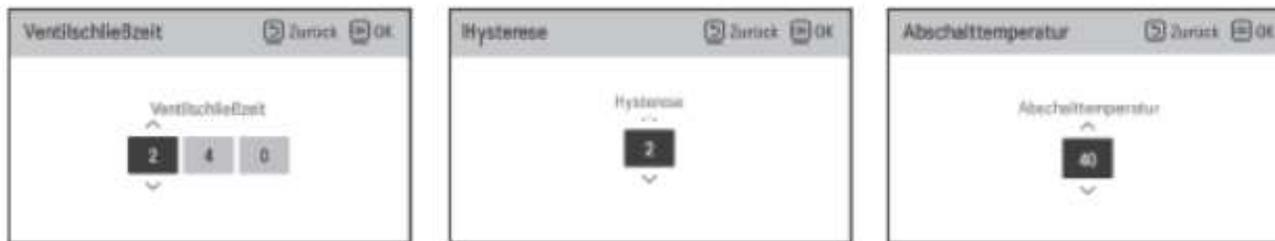
Jedes Mischerventil besitzt eine spezifische Ventilschließzeit (steht meist darauf), welche unter **Ventilschließzeit** auf der Fernbedienung einzustellen ist. Ansonsten wird der Regelkreis nicht korrekt funktionieren.
