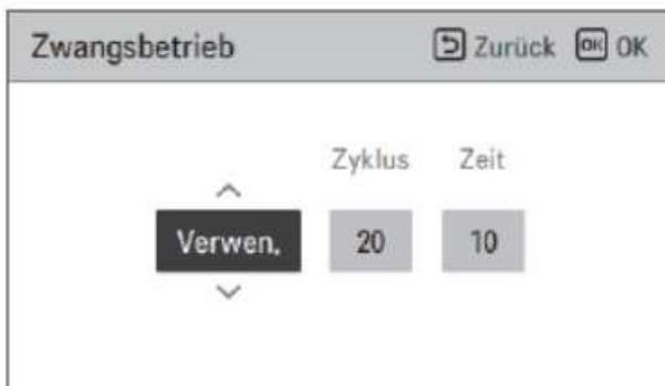
Der Zwangsbetrieb regelt den Betrieb der internen Wasserpumpe ( Primärkreispumpe) in der Wärmepumpe.
