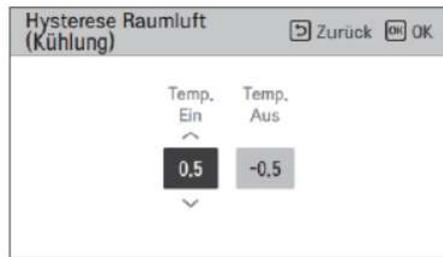
Mit der Einstellung der „Hysterese Raumluf Kühlung“ bestimmen sie den Temperaturabstand zwischen dem Aus- und Einschaltpunkt des Kühlbetriebes (Hysterese) wenn sie eine Lufttemperatur als Regelgröße der Wärmepumpe gewählt haben. Sie können zwischen den Werten in der Tabelle wählen ( oberes und unteres Totband).
