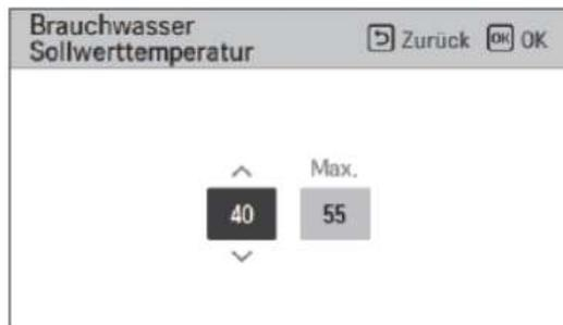
Hier wählen sie den Temperaturbereich für die Brauchwassererwärmung, welche auf der Bedienebene eingestellt werden kann ( Siehe Tabelle ).
