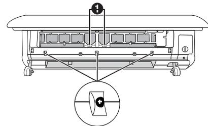
3. Öffnen Sie die Schraubenabdeckung an der Unterseite des Luftauslassrahmens und entfernen Sie dann mit einem Schraubendreher die 2 schwarzen Schrauben.
