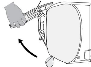
2. Entfernen Sie mit einem Schraubendreher 3 schwarze Schrauben an der Oberseite des Luftaustrittsrahmens. Legen Sie danach die Schrauben in dem Aufbewahrungsfach ❶ ab.
