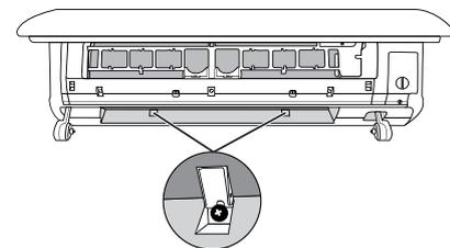
4. Ziehen Sie den Luftauslassrahmen gemäß der Abbildung nach außen und entfernen Sie ihn dann.
