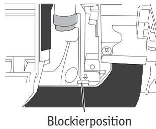
2. Wenn die Kondensatwanne montiert ist, befestigen Sie sie mit den zuvor bei der Demontage entfernten 4 Schrauben.
