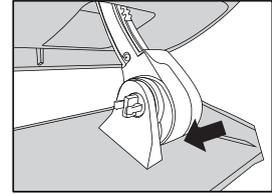
2. Wiederholen Sie den Vorgang nun auf der linken Seite und montieren Sie die Luftleitlamelle gemäß der in der Abbildung gezeigten Richtung.
