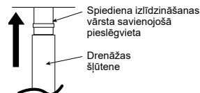
Ilustrācija, kā piestiprināt drenāžas šūteni ierīcei
