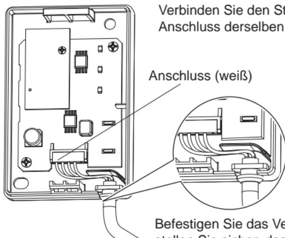
Verbinden Sie den Stecker mit dem Anschluss derselben Farbe.
