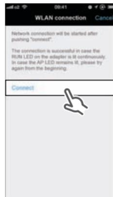
(7) Nach Implementierung der oben beschriebenen Einstellungen und wenn das Produkt und der Router (WLAN-Zugriffspunkt) verbunden sind, leuchtet die LED [RUN] auf. Wenn diese LED eine Minute oder länger blinkt, überprüfen Sie die Stromversorgung des Routers (WLAN-Zugriffspunkt), den Netzwerknamen und das Passwort und beginnen Sie erneut ab dem ersten Vorgang.
