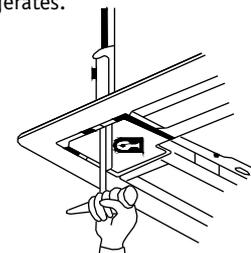
2. Wenn nach der Installation immer noch eine Lücke zwischen Decke und Abdeckung besteht, justieren Sie das gesamte Gerät, bis es passgenau mit der Decke abschließt.
