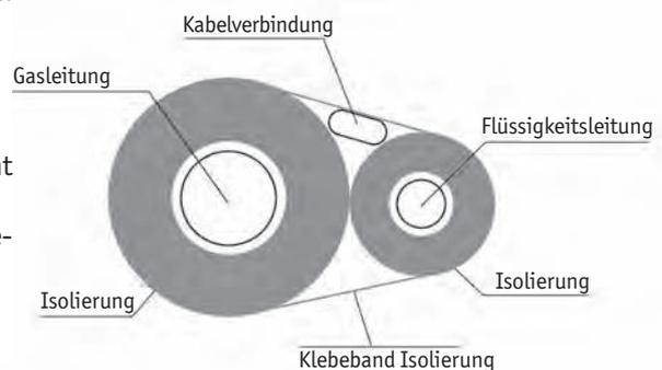
Ermitteln Sie aus der Tabelle die geeignete Stärke der Isolierung für Gas- und Flüssigkeitsleitungen
