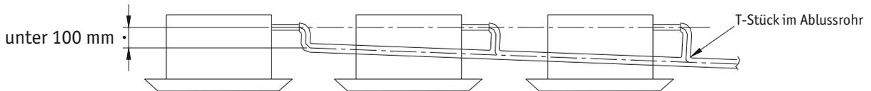
Die Dimension des ausgewählten Ablaufschlauches sollte der Laufleistung des Gerätes angepasst sein.
