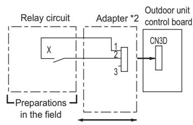
X : Relay Contact rating voltage  $\geq 15\text{VDC}$
