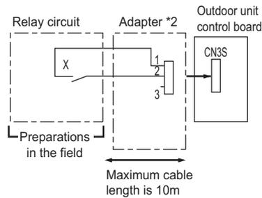
X : Relay Contact rating voltage  $\geq 15\text{VDC}$
