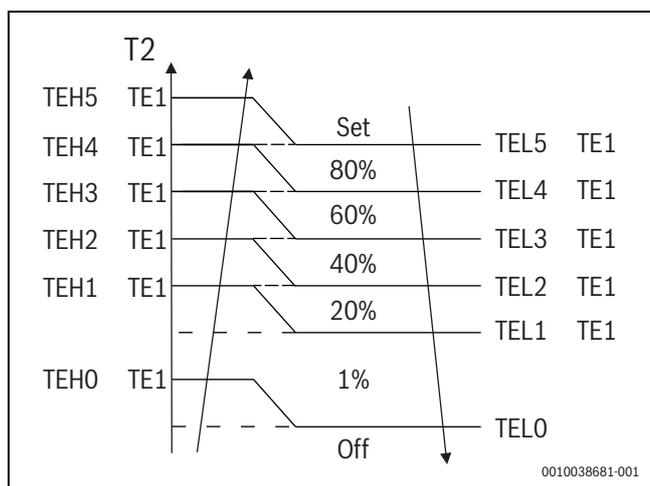
Bild 12 Anti-Kaltluft-Funktion
