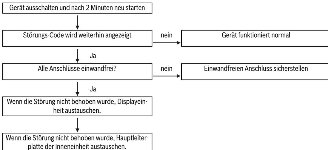
**8.5.7 EH 03: Drehzahl des Ventilators der Inneneinheit liegt außerhalb des normalen Bereichs**
