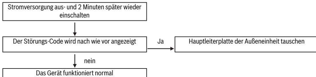
**8.5.4 EC 52-54: Unterbrechung oder Kurzschluss am Außentemperaturfühler (T3, T4, TP)**
