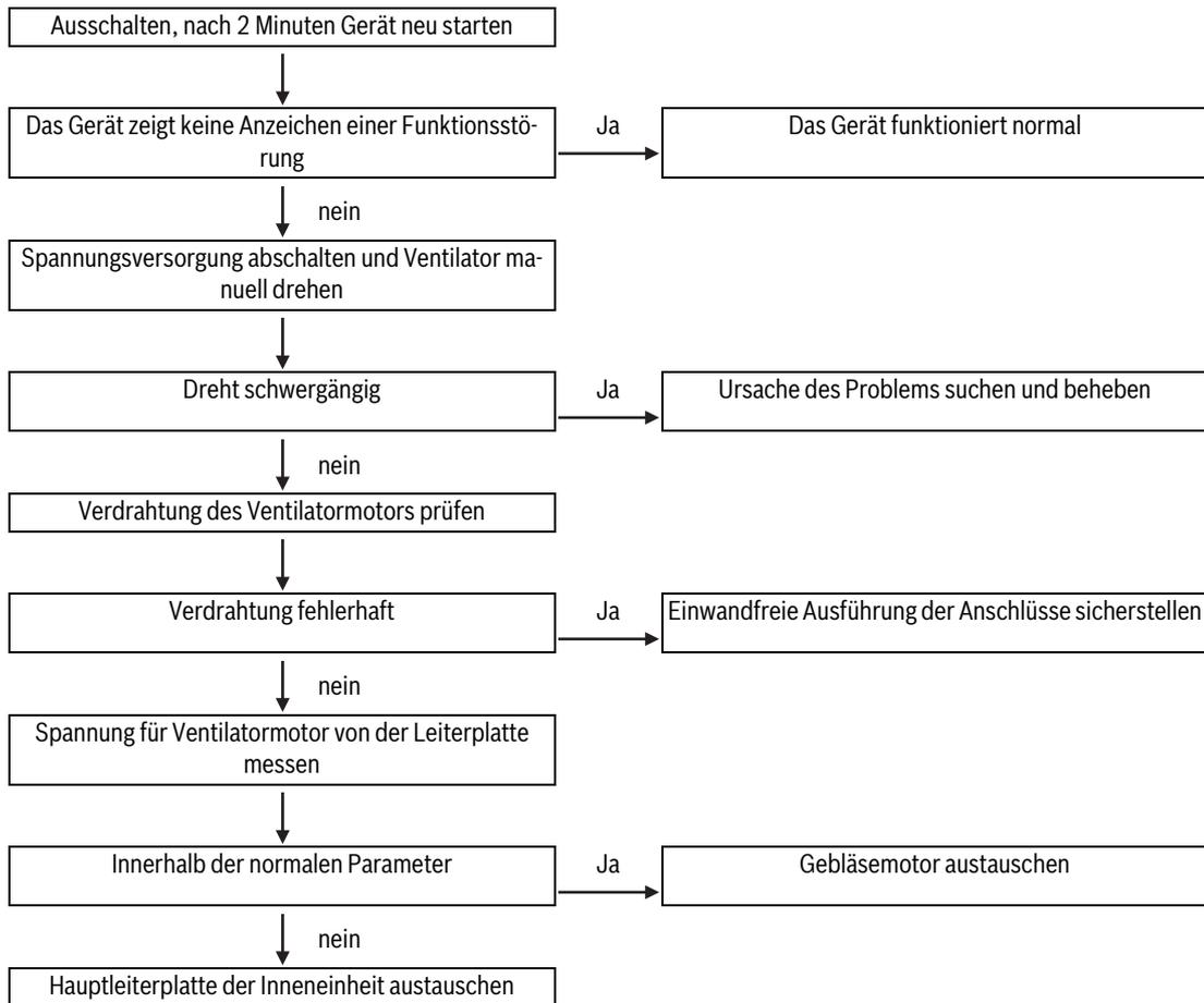
**8.5.8 EH 60-61: Unterbrechung oder Kurzschluss am Innentemperaturfühler (T1, T2)**
