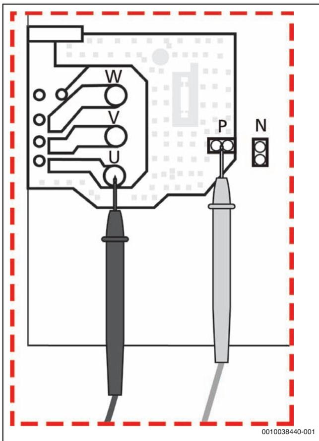
Bild 79 IPM-Durchgangsprüfung
