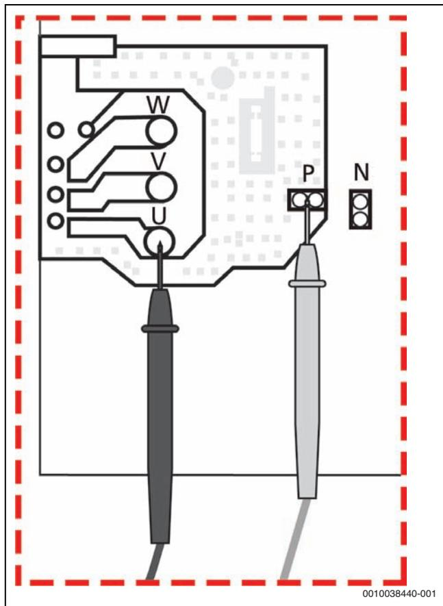
Bild 85 IPM-Durchgangsprüfung
