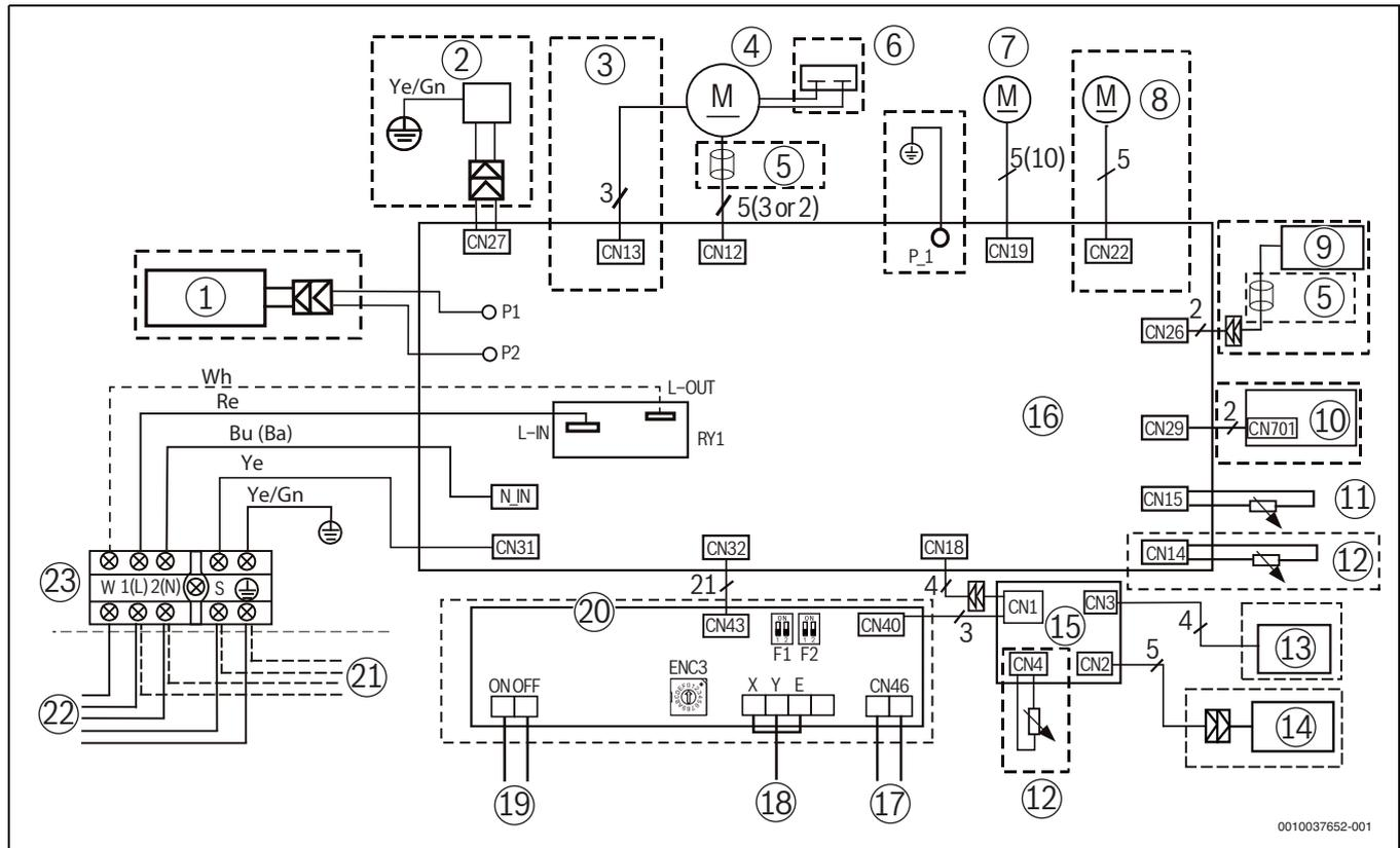
Bild 4 Schaltplan für Inneneinheiten mit 9 bis 18 kBTU/h
