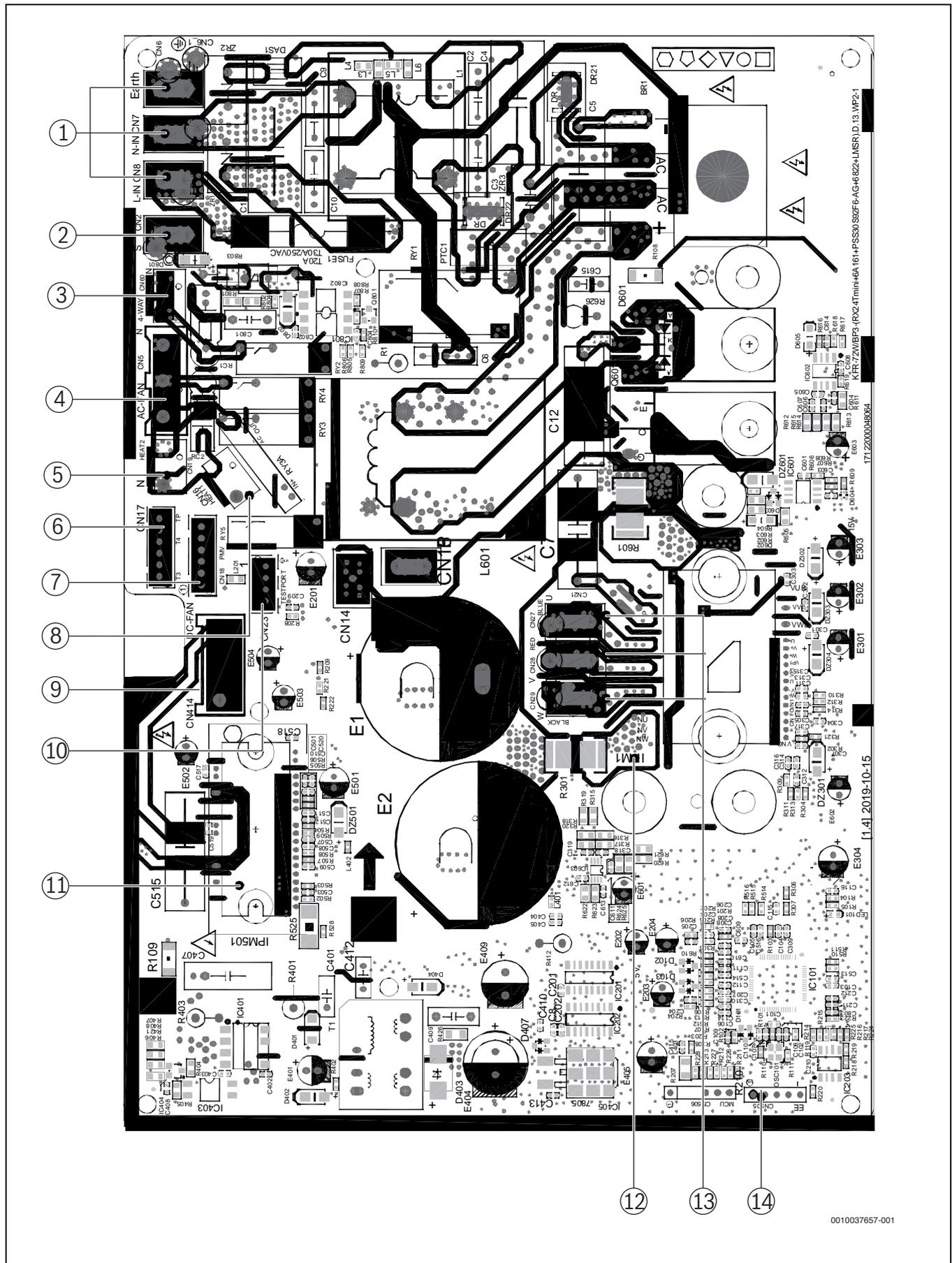
Bild 9 Hauptleiterplattenanschlüsse für Außeneinheiten mit 24 kBTU/h
