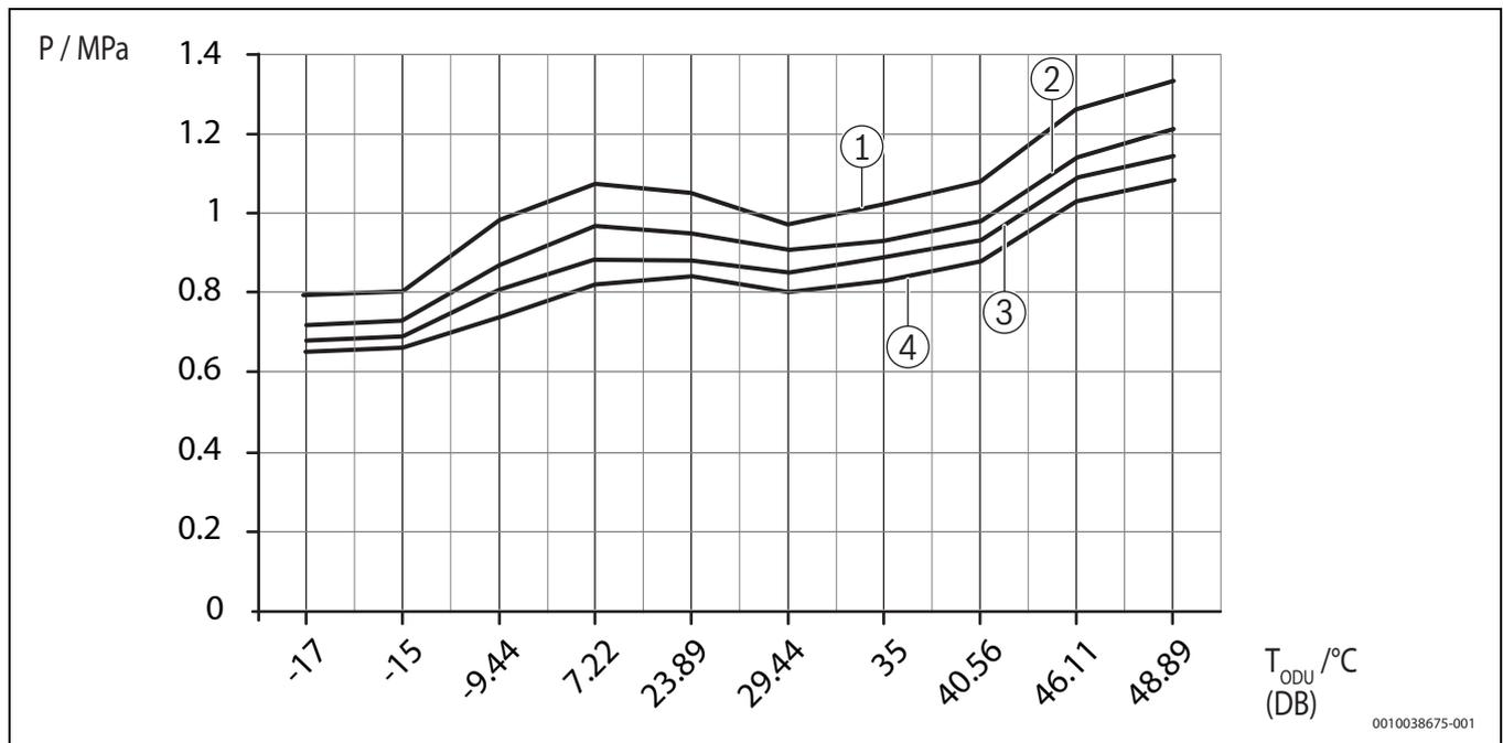
Bild 15 Druck am Wartungsanschluss im Kühlbetrieb
