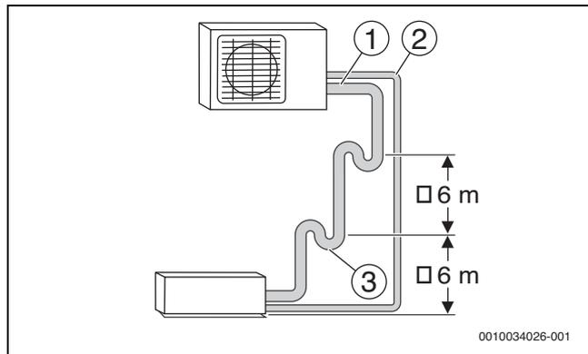
Bild 1 Installation der Außeneinheit über der Inneneinheit
