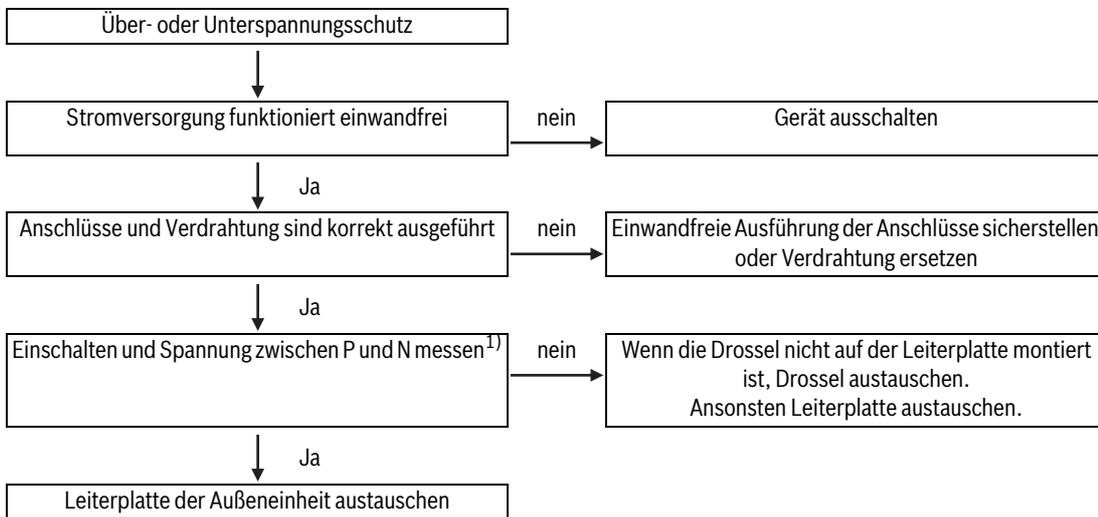
1) Während der Betriebsbereitschaft des Geräts liegt die Spannung zwischen P und N bei etwa 310 V, 340 V oder 380 V (Gleichstrom). Beim Geräteanlauf liegt sie im Bereich zwischen 220 V und 400 V.
