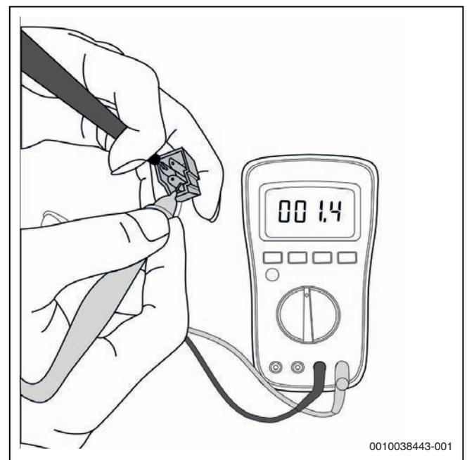
Bild 87 Kompressorprüfung
