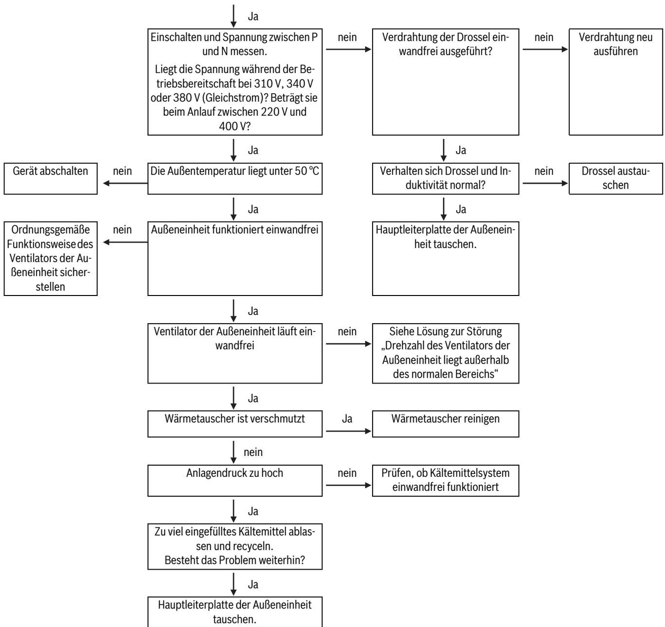
**8.5.12 PC 00: IPM-Störung oder IGBT-Überstromschutz**
