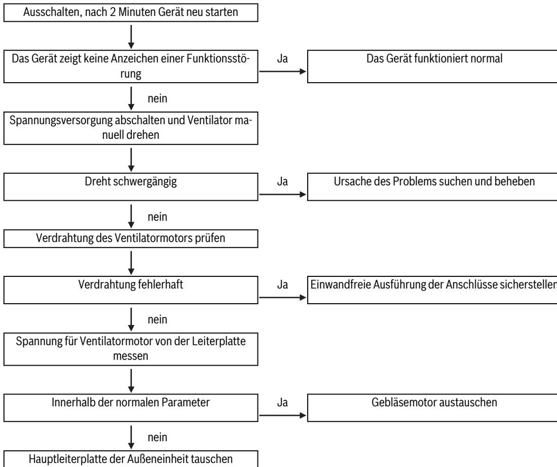
**8.5.3 EC 51: Außeneinheit – EEPROM-Parameterfehler oder EEPROM-Parameterfehler von angesteuertem Kompressor-Chip****Digitalanzeige**
