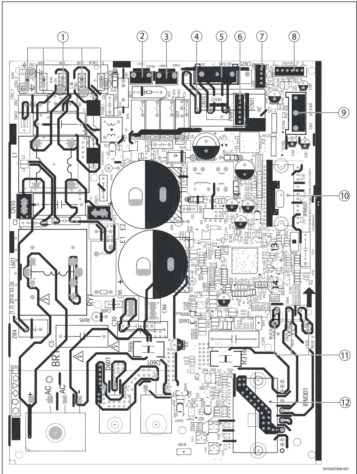
Bild 8 Hauptleiterplattenanschlüsse für Außeneinheiten mit 9 bis 18 kBTU/h
