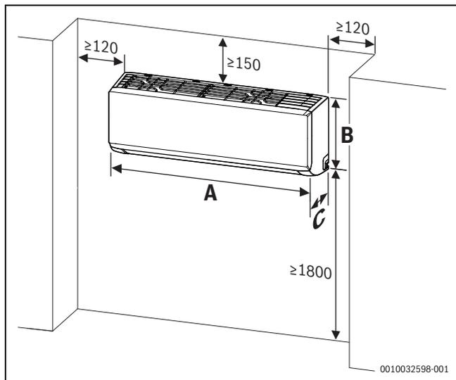
Bild 2 Abmessungen der Inneneinheit
