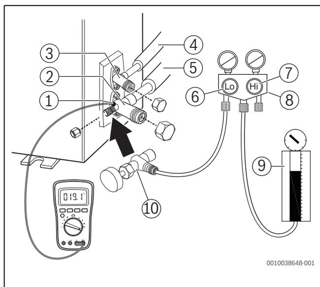
Bild 13 Kältemittelnachfüllung
