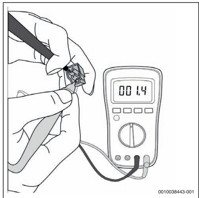
Bild 78 Kompressorprüfung
