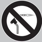
Das abgedrehte Rohrleitungsende NIEMALS durch Lötten entfernen.
