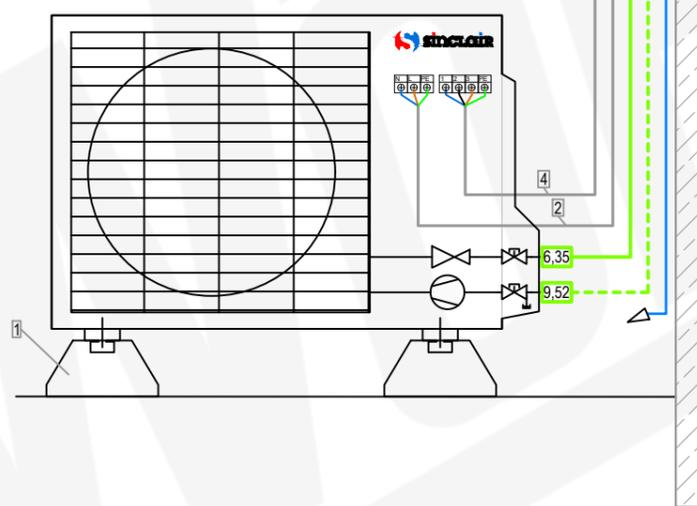
Kondensatablauf mit Kanalpumpe FL-K20K-SW links
